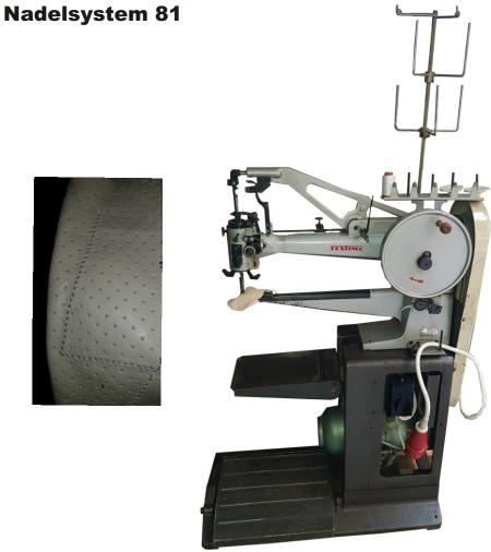
Sehr schöne Textima Freiarmnähmschine Model 8346-20, Bj. ca. 1989, gebrauchter und einwandfreier Zustand mit Kraftstromanschluß 380V, stufenlos über Fußbetrieb nutzbar. Umstellung auf Handbetrieb auch möglich, inkl. Arbeitsvorrichtung zum sitzend nähen. Sehr schönes und sauberes Nahtbild. Zusätzlich Rollenmagazin für Nähgarn - dieses ist abnehmbar. Die Maschine ist generalüberholt - das Nadelsystem 81 ist gängig und wie Ersatzteile jederzeit bestellbar. **Maschinen Nr. 2018-37009**
